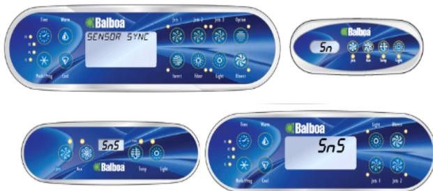
Lorsque vous avez des codes Sn, SnA, Sn1, Sn2, Sn3, HL, EO, Prh, ... etc, cela fait référence aux sondes de température généralement présentes sur le tube du réchauffeur. Ils vous indiquent alors que la sonde Hi-limit ou la sonde de température sont ouvertes ou court-circuitées, qu'un défaut au niveau du voltage à créer une surchauffe de l'eau.
