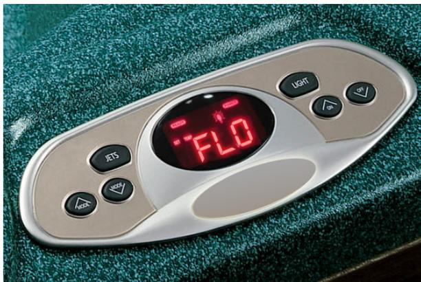
Ces codes sont liés à des problèmes de débit ou au régulateur de pression/débit, et sont de loin les codes d'erreur les plus fréquents. Ces codes erreurs sont dus à différentes raisons. La plus fréquente étant l'écoulement de l'eau dans le système de contrôle du spa. Si l'eau ne s'écoule pas à un rythme satisfaisant pour le régulateur de pression, l'un des codes d'erreur ci-dessus peut apparaître.
