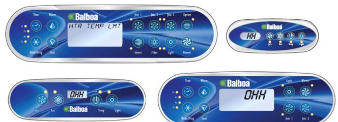
réchauffeur et en faisant fonctionner la pompe de circulation et le blower (s'il y en a un). Si votre spa est effectivement en train de surchauffer, trois raisons sont possibles : un problème de débit, une sonde de température défectueuse ou les relais du circuit imprimé permettant de faire fonctionner le réchauffeur coincés en position fermée. Si tel est le cas pour ce dernier, remplacez le circuit imprimé.
